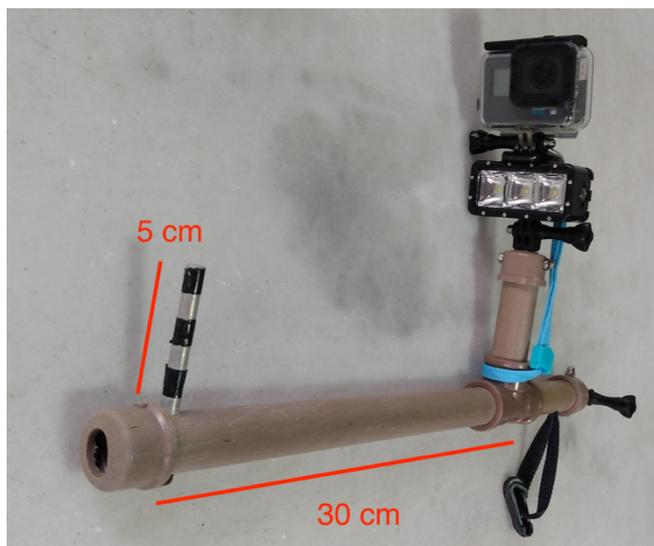
A captação das imagens pelos mergulhadores foi feita a uma velocidade linear de aproximadamente 1 metro a cada 4 segundos, com a haste de filmagem perpendicular a superfície ou substrato alvo.
